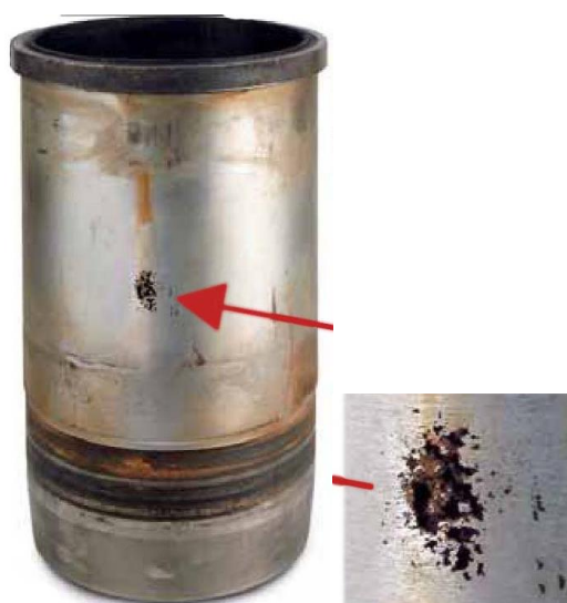
4-сурет - Цилиндр жеңінің ақауының мысалы
